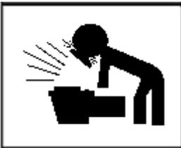
**⚠ ADVERTENCIA** - Si se está probando la presión de la bomba (50 PSI MÁXIMO), asegúrese de que se haya liberado la presión, utilizando la válvula de alivio de aire manual del filtro, antes de quitar la tapa del colador.
